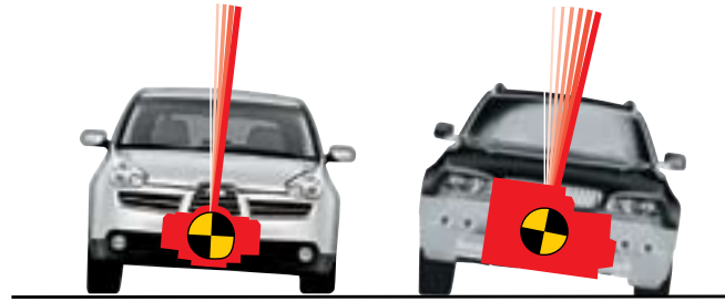
Le bas centre de gravité du moteur BOXER SUBARU produit moins de roulis que les moteurs en V ou en ligne.
