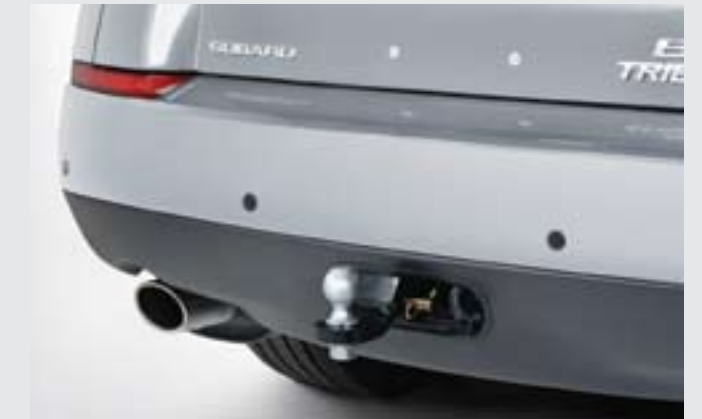
Le sonar de marche arrière offert sur la B9 Tribeca émet un signal sonore lorsque le véhicule recule et qu'un obstacle est à moins de cinq pieds. Le nécessaire de remorquage permet de tracter une charge maximale de 1 588 kg (3 500 lb) et comprend un refroidisseur d'huile de transmission, un faisceau de fils et une barre de remorquage. (Boule d'attelage non comprise)
