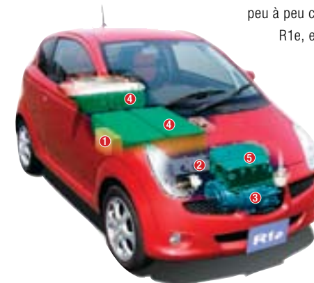
① Chargeur de batterie ② Convertisseur CC-CC ③ Moteur électrique ④ Batterie Mn Li-ion ⑤ Convertisseur
