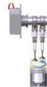
En ouvrant chaque soupape à un degré différent, on crée un effet de tourbillonnement qui optimise le mélange air-essence, améliorant ainsi la combustion, la puissance et l'économie de carburant.
