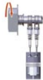
En ouvrant les deux soupapes au maximum, on permet à une plus grande masse d'air d'entrer dans la chambre de combustion, améliorant ainsi l'efficacité de la combustion et la puissance produite.
