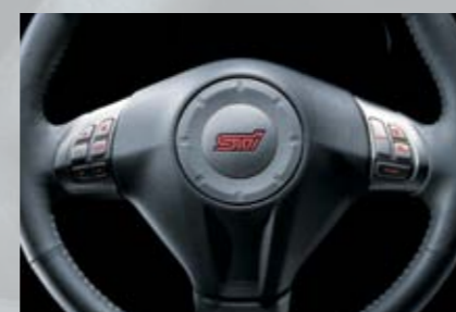
Commandes du régulateur de vitesse et de la chaîne audio intégrées au volant
