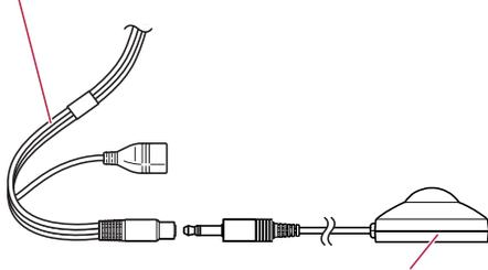
Microphone pour la mesure acoustique
