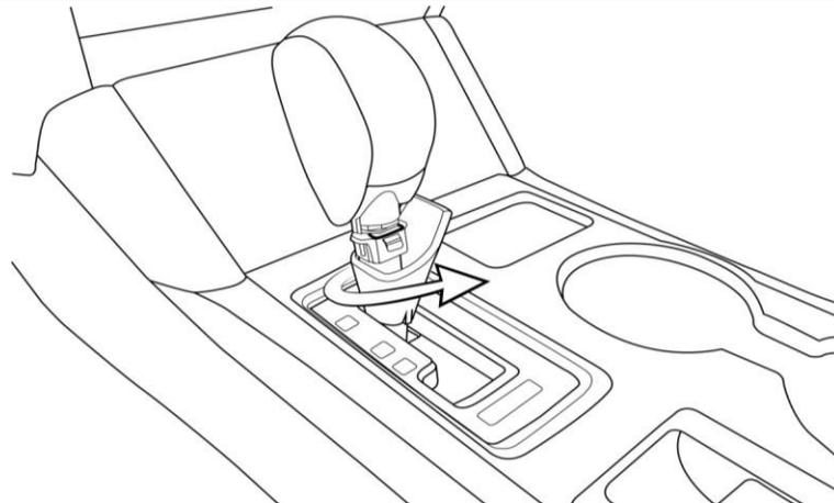
**ÉTAPE 3** : NOTEZ L'EMPLACEMENT ET L'ORIENTATION DE L'AGRAFE DE RETENUE, PUIS RETIREZ-LA. TIREZ L'AGRAFE DE RETENUE VERS L'ARRIÈRE DU VÉHICULE.
