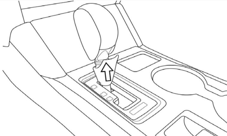
**ÉTAPE 9** : CONFIRMEZ QUE LE POMMEAU DE LEVIER DE VITESSES EST SOLIDEMENT INSTALLÉ ET QUE LE BOUTON PEUT ÊTRE ENFONCÉ COMPLÈTEMENT. ASSUREZ-VOUS QUE LE POMMEAU DE LEVIER DE VITESSES EST INSTALLÉ ADÉQUATEMENT AVANT D'UTILISER LE VÉHICULE. DÉMARREZ LE MOTEUR, MAINTENEZ ENFONCÉE LA PÉDALE DE FREIN ET CONFIRMEZ QUE LE LEVIER DE CHANGEMENT DE VITESSES NE PEUT PAS ÊTRE SORTI DE LA POSITION « P » SANS APPUYER SUR LE BOUTON.
