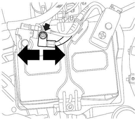
Débrancher le fil de mise à la masse de la batterie.
