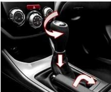
Débranchez le câble négatif de la batterie et assurez-vous que le frein de stationnement est serré fermement. Tirez doucement la gaine du levier de vitesses vers le bas en l'éloignant du pommeau de levier de vitesses d'origine. Retirez le pommeau en le tournant dans le sens antihoraire.
