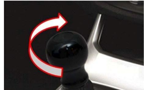
Nettoyez les filetages exposés à l'aide d'une brosse. Installez le nouveau pommeau en le tournant dans le sens horaire. Nettoyez le pommeau avec un chiffon non pelucheux et de l'alcool isopropylique. Assurez-vous que la surface où l'autocollant sera placé est propre et exempte de peluches. Utilisez un séchoir si nécessaire.
