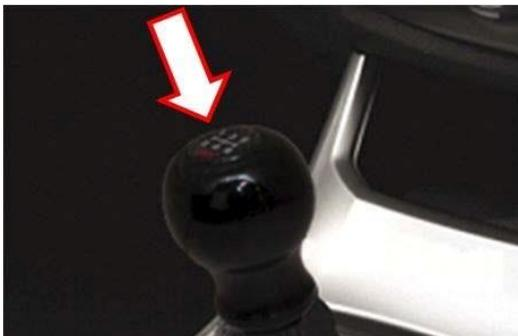
Placez l'autocollant des positions de vitesses sur le pommeau.
