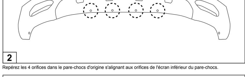
Repérez les 4 orifices dans le pare-chocs d'origine s'alignant aux orifices de l'écran inférieur du pare-chocs.
