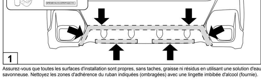
Assurez-vous que toutes les surfaces d'installation sont propres, sans taches, graisse ni résidus en utilisant une solution d'eau savonneuse. Nettoyez les zones d'adhérence du ruban indiquées (ombragées) avec une lingette imbibée d'alcool (fournie).
