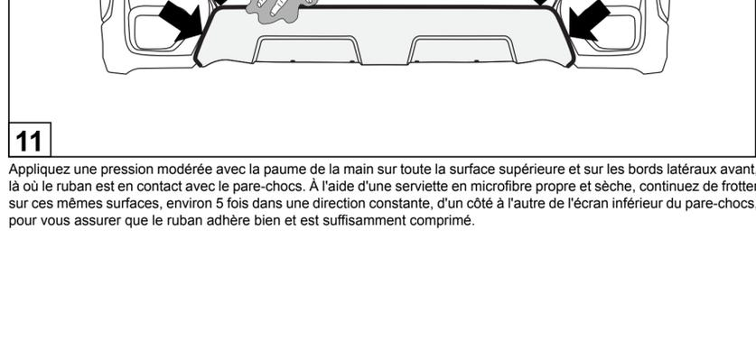
Appliquez une pression modérée avec la paume de main sur toute la surface supérieure et sur les bords latéraux avant, là où le ruban est en contact avec le pare-chocs. À l'aide d'une serviette en microfibre propre et sèche, continuez de frotter sur ces mêmes surfaces, environ 5 fois dans une direction constante, d'un côté à l'autre de l'écran inférieur du pare-chocs, pour vous assurer que le ruban adhère bien et est suffisamment comprimé.
