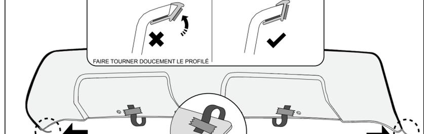
Vérifiez que le joint d'étanchéité est compatible avec l'écran inférieur du pare-chocs avant l'installation. Au besoin, frottez le joint d'étanchéité afin qu'il ne s'écarte pas du rebord de l'écran inférieur du pare-chocs. Décollez les doublures des rubans d'environ 50 mm (2 po) à chaque extrémité de la pièce et pliez-les à 45 degrés par rapport à la pièce. Fixez les doublures de ruban décollées sur la surface extérieure de l'écran inférieur du pare-chocs à l'aide de ruban-cache.
