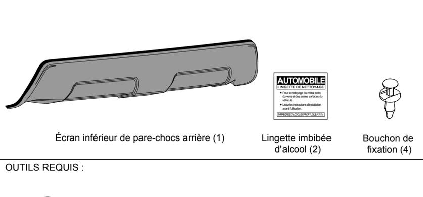
Écran inférieur de pare-chocs arrière (1)      Lingette imbibée d'alcool (2)      Bouchon de fixation (4)
