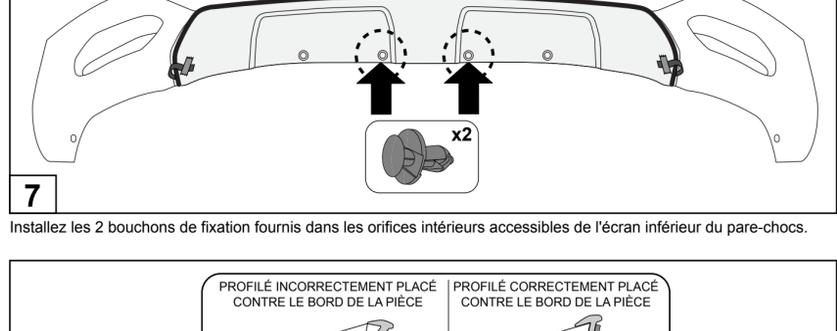
Installez les 2 bouchons de fixation fournis dans les orifices intérieurs accessibles de l'écran inférieur du pare-chocs.
