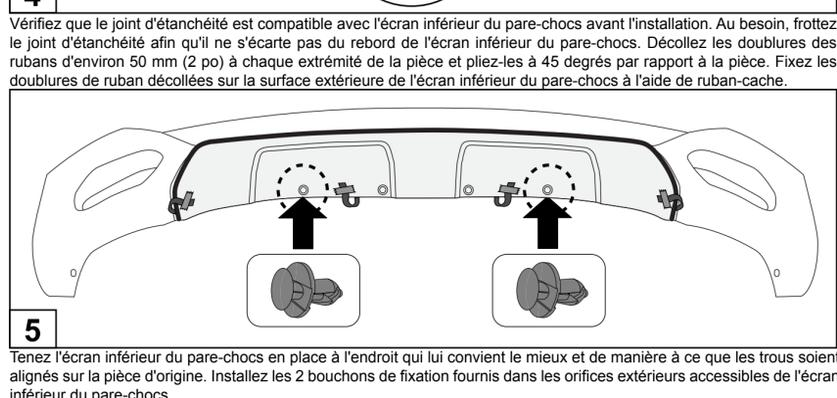
Tenez l'écran inférieur du pare-chocs en place à l'endroit qui convient le mieux et de manière à ce que les trous soient alignés sur la pièce d'origine. Installez les 2 bouchons de fixation fournis dans les orifices extérieurs accessibles de l'écran inférieur du pare-chocs.
