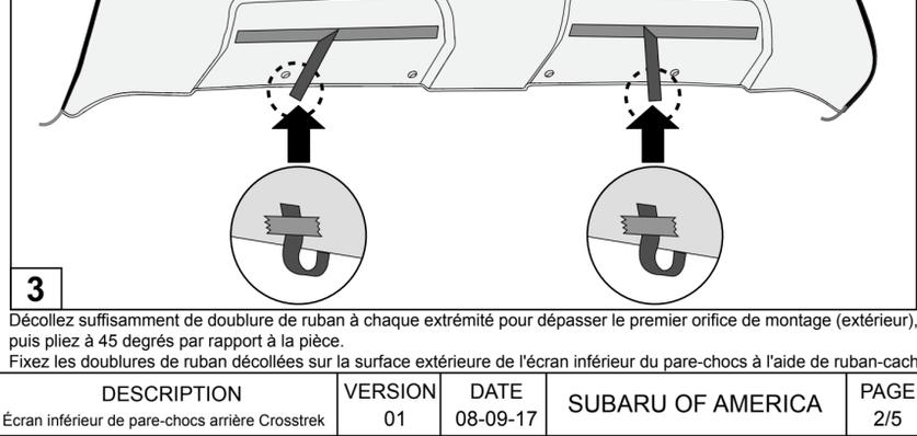
Détachez suffisamment de doublure de ruban à chaque extrémité pour dépasser le premier orifice de montage (extérieur), puis pliez à 45 degrés par rapport à la pièce. Fixez les doublures de ruban décollées sur la surface extérieure de l'écran inférieur du pare-chocs à l'aide de ruban-cache.
