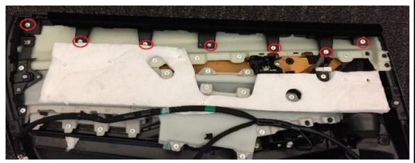
11 : Détachez les sept attaches maintenant le panneau de garniture en place en dégageant délicatement les attaches et tirant sur la garniture.
