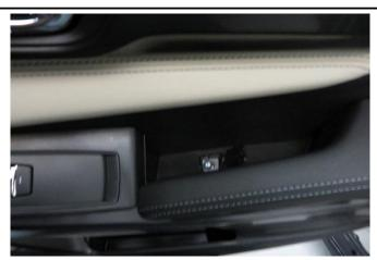
3 : Utilisez vos doigts pour soulever la partie supérieure du panneau en plastique et le retirer (prenez note des emplacements des attaches).
