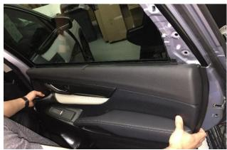
6 : Retirez d'abord le verrou de porte ainsi que les câbles du mécanisme de verrouillage de la porte.
