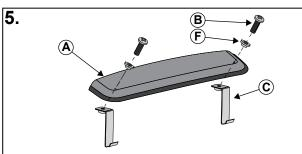
Fixez sans serrer les attaches (C) sur le déflecteur (A) avec les vis (B) et les rondelles (F) fournies. L'ordre est le suivant : vis (B), rondelle (F), lame (A) et attache (C).
