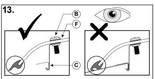
Avant de serrer, assurez-vous que le joint en caoutchouc est bien à plat contre le toit et non tordu sur lui-même.
