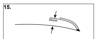
Le déflecteur d'air ne doit pas dépasser plus de 30 mm au-dessus de la vitre du toit ouvrant au point milieu. Si le déflecteur dépasse de plus de 30 mm, vérifiez s'il est bien monté et si les vis et les écrous sont solidement serrés.
