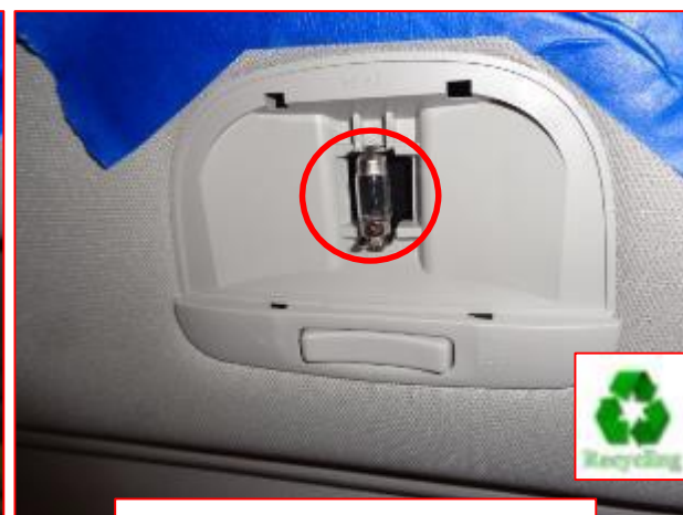
Retirer l'ampoule d'origine
