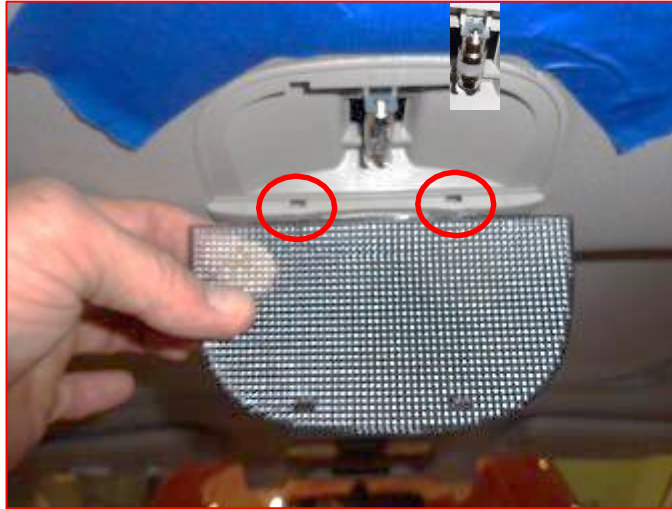
Aligner les (2) petites attaches sur le logement
