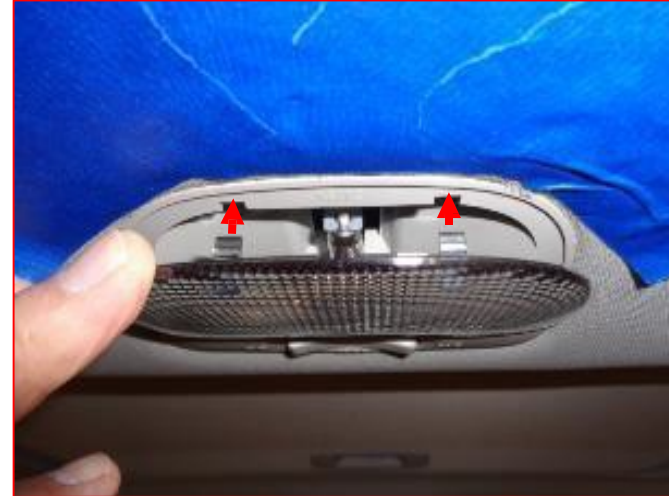
Aligner les (2) grosses attaches sur le logement et encliqueter en place
