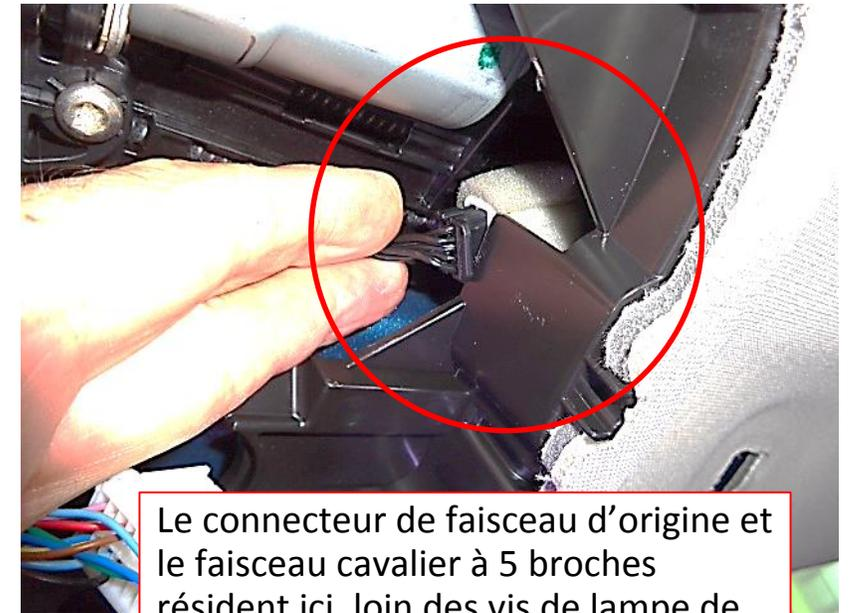
Le connecteur de faisceau d'origine et le faisceau cavalier à 5 broches résident ici, loin des vis de lampe de lecture et de toute zone de pincement potentiel.
