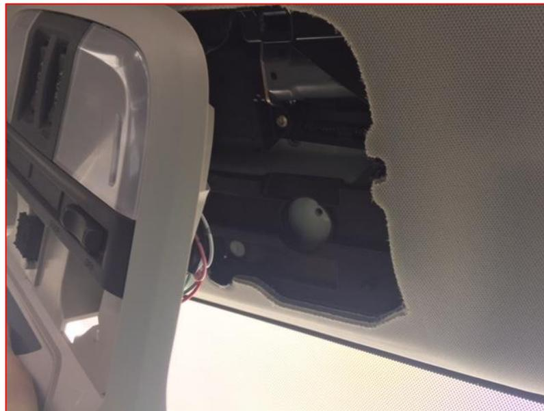
**⚠** Prendre les précautions nécessaires pour éviter d'endommager les fils et connecteurs en retirant la lampe du pavillon.
