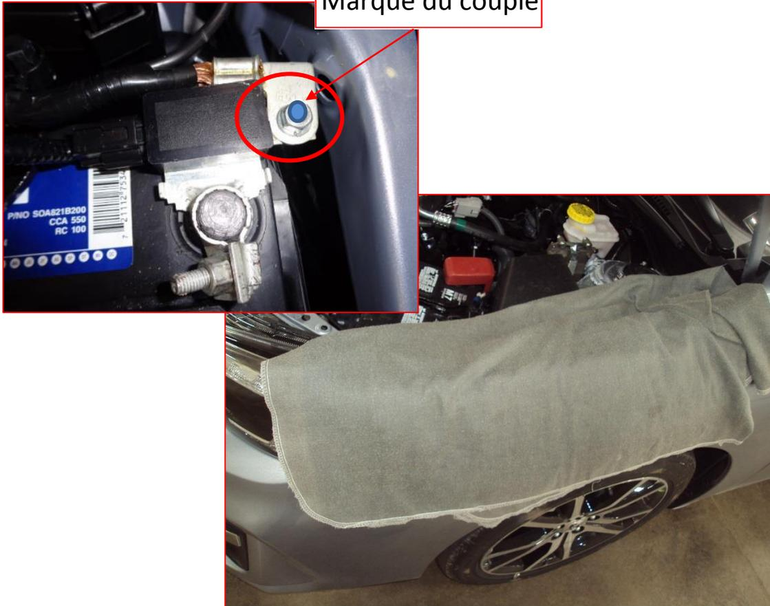
Avec l'aile avant gauche protégée, utiliser un cliquet à prise de ¼ po et une douille de 10 mm pour réinstaller le câble négatif sur le goujon de la borne négative de la batterie. À l'aide d'une clé dynamométrique à prise de 1/4 po, serrer l'écrou de 10 mm sur le goujon à 66 po-lb de couple. Ne pas serrer à l'excès.
