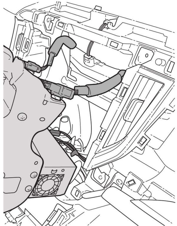
13. Retirez le logement de la console centrale sous le panneau du port USB. Retirez le capuchon en plastique de chaque côté du boîtier de la console centrale près de l'ancrage de la ceinture sécurité de façon à révéler le boulon de 10 mm. Retirez les (2) boulons.
