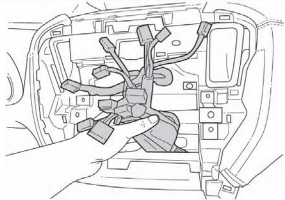
22. Branchez le faisceau adaptateur et les connecteurs à 6 et à 10 broches à l'unité centrale. Rebranchez avec soin tous les connecteurs restants à la radio et au module télématique. Réinstallez l'ensemble de la radio sur le tableau de bord. Serrez les boulons de 10 mm à 16 po-lb (1,8 N m).
