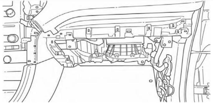
12. Desserrez le montant B en dégageant l'agrafe inférieure.
