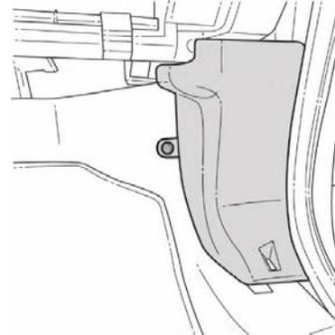
10. Déposez le panneau de la boîte à gants en retirant les six (6) vis. Assurez-vous de débrancher la lumière de la boîte à gants.
