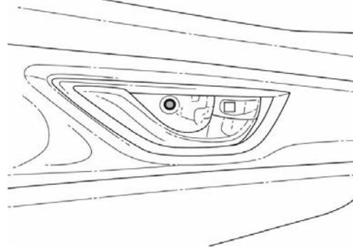
25. À l'intérieur de la poignée de l'accoudoir, retirez le cache-vis à l'aide d'un petit tournevis fendu. Déposez la vis.
