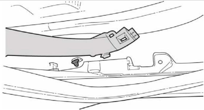
13. Acheminez le faisceau d'alimentation des accessoires à partir du logement de la radio jusque dans l'ouverture de boîte à gants, tel qu'illustré. Alignez le ruban-mousse avec la ferrure métallique.
