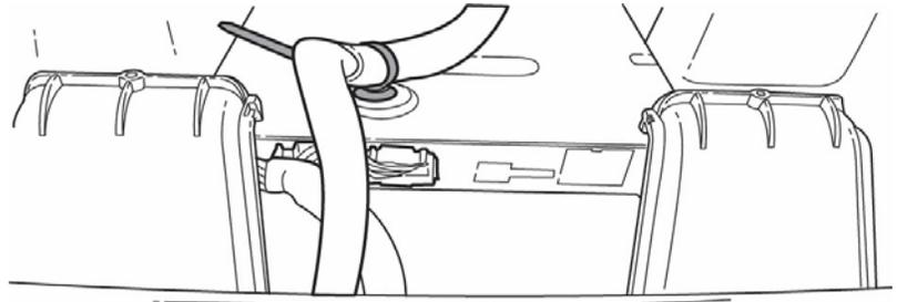
21. Branchez les connecteurs à 6 et à 10 broches enrobés d'isolant du faisceau de l'amplificateur aux connecteurs de la radio sur le faisceau des accessoires. Trouvez le connecteur d'alimentation à deux broches déjà préparé et fixé au faisceau des accessoires avec du ruban rose amovible. Branchez le connecteur à deux broches à la prise à deux broches sur le faisceau de l'amplificateur.
