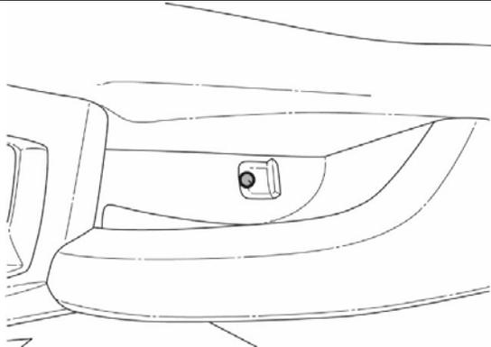
26. Délogez le bas du panneau de porte. Soulevez pour dégager le panneau de la porte. Vérifiez qu'aucune des huit (8) agrafes ne reste dans la tôle de la porte. Si des agrafes sont demeurées dans la tôle, déposez-les et réinstallez-les à leur emplacement respectif dans le panneau de garniture de porte en plastique.
