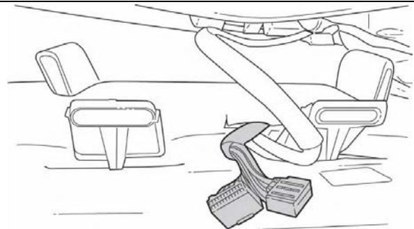
19. Placez l'amplificateur sous le siège et alignez les attaches avec les deux (2) goujons filetés situés sous deux coupes de décharge dans le tapis. Branchez le faisceau à l'amplificateur en joignant les connecteurs aux prises correspondantes. Fixez l'amplificateur aux goujons du plancher avec les (2) écrous fournis et serrez jusqu'à 66 po-lb (7,5 N m +/- 2).
