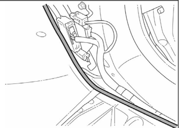
16. Acheminez le câblage le long du joint de porte et du faisceau de câblage du véhicule. Fixez le faisceau audio au faisceau du véhicule où il y a ruban blanc de repère à l'aide d'un (1) serre-fils.
