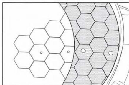
32. Fixez l'écusson en installant les anneaux de retenue à l'arrière du panneau.
