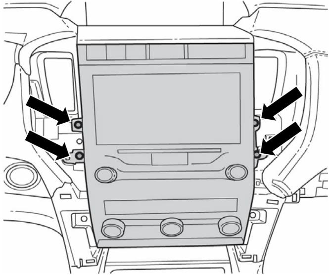
6. Tirez la radio vers vous et débranchez avec soin les connecteurs de la radio et du module télématique; mettez l'ensemble de côté.
