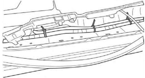
18. Faisceau d'alimentation sous le siège. Le faisceau de câblage de l'amplificateur devrait sortir du tapis par le même orifice que la bouche d'air du côté droit (tel qu'illustré). Ajustez pour que le jeu dans le câblage demeure sous le tapis.
