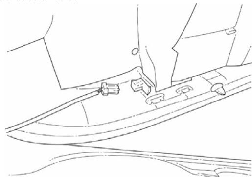
28. Débranchez le faisceau du haut-parleur et déposez les quatre (4) vis fixant le haut-parleur à la porte. Déposez le haut-parleur et mettez de côté.
