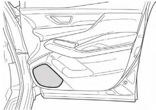
24. Retirez le cache-vis à l'aide d'un petit tournevis fendu. Déposez la vis.
