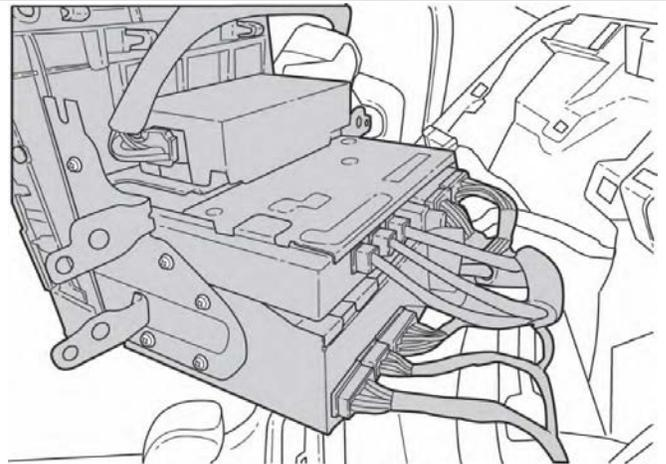
7. Déposez les panneaux de garniture au-dessus et à droite du coffre à gants.
