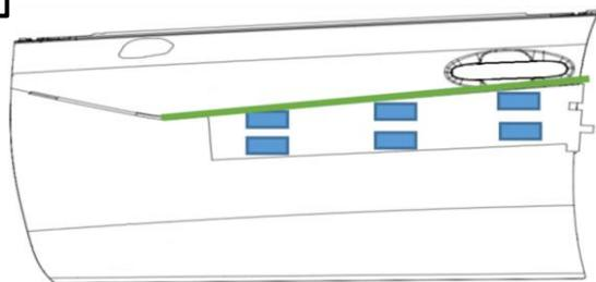
Couper six (6) morceaux de ruban-cache (faible adhérence), lesquels doivent être apposés aux six (6) emplacements rectangulaires du gabarit de la porte avant gauche de façon à tenir celui-ci en place.
