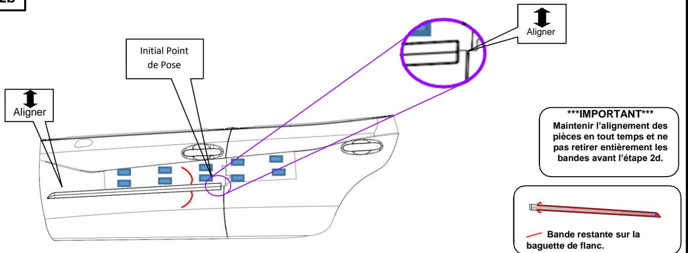
Aligner la baguette de flanc du côté avant gauche avec le gabarit avant (grand gabarit). Le côté supérieur de la baguette de flanc devrait être aligné avec le côté inférieur du gabarit avant. Utiliser une main pour tenir la baguette de flanc bien alignée et l'autre main pour appuyer doucement la baguette de flanc contre le point de pose initial sur le véhicule.
