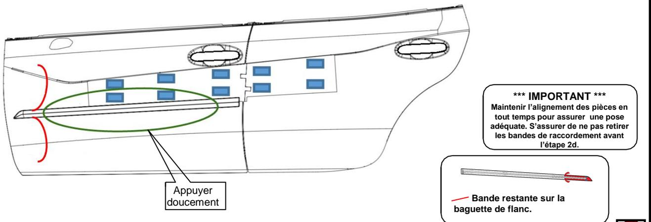
Utiliser une main pour tenir la baguette de flanc bien alignée; continuer de tirer sur la bande de tirage (2) jusqu'à ce qu'elle soit retirée sur les trois quarts (environ) de la baguette de flanc. Maintenir la baguette de flanc bien alignée; appuyer doucement au centre de la baguette de flanc de façon à commencer l'application de celle-ci.
