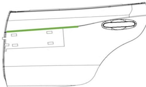
Aligner le gabarit de la baguette de flanc arrière avec la ligne distinctive de la porte arrière; ne pas apposer de ruban-cache avant les étapes 1f et 1g.
