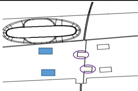
S'assurer que les languettes au centre des gabarits avant et arrière sont bien alignées avant de coller le gabarit arrière sur le véhicule à l'aide du ruban-cache.
