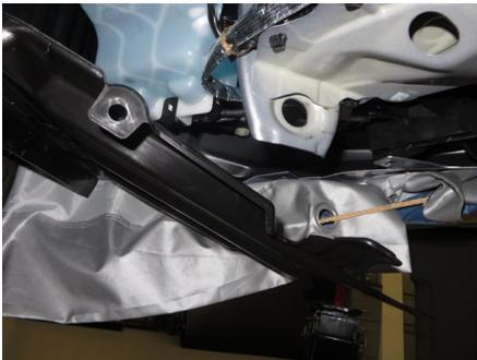
Enlevez la vis autotaraudeuse 10mm et deux bouchons expansibles du garde-boue côté gauche, enlevez le garde-boue et mettez de côté.
