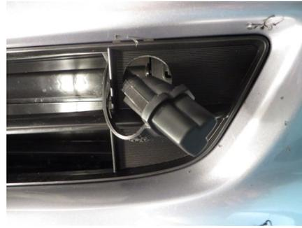
En utilisant le protecteur de fiche d'alimentation électrique mâle, fixez la fiche mâle à l'ouverture préalablement percée dans la partie inférieure de
