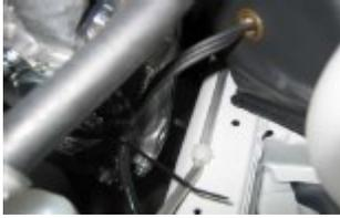
Dirigez le câblage vers le bas du véhicule et fixez le câblage du chauffe-batterie au câblage du moteur avec l'attache-métallique fournie tel que démontré.
