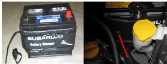
Enroulez le chauffe-batterie autour de la batterie avec le côté imprimé vers l'extérieur. Bien ajuster le chauffe-batterie dans les coins. Utilisez les courroies d'attaches fournies pour fixer le chauffe-batterie tel que démontré. Installez le chauffe-batterie autour de la batterie avec le fil électrique sortant vers l'avant tel que démontré.
