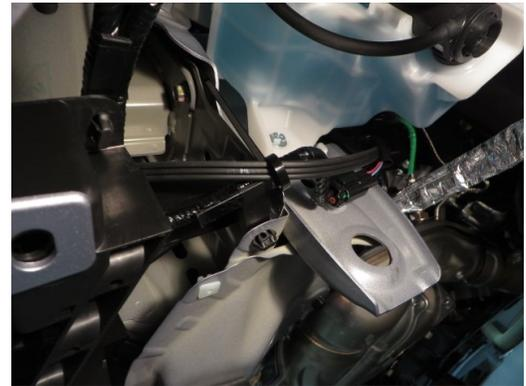
Dirigez le câblage du chauffe-batterie au-dessus du crochet de remorquage. Utilisez une courroie d'attache de plastique noire pour fixer le câblage du chauffe-batterie au câblage du véhicule à la section profilé en T. Dirigez le câblage autour du radiateur en direction de la calandre avant.
