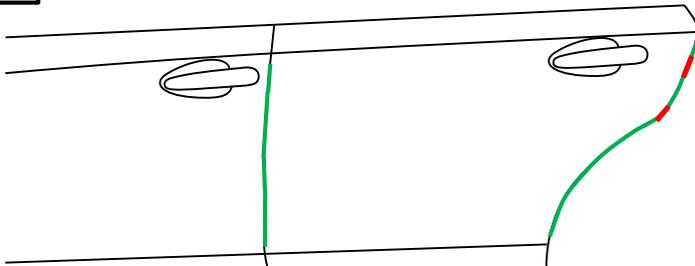
VÉRIFIEZ L'ÉTANCHÉITÉ DANS LES ZONES INDIQUÉES PAR UNE LIGNE VERTE. LES LIGNES ROUGES INDIQUENT LES ENDROITS OÙ IL N'EST PAS NÉCESSAIRE DE VÉRIFIER L'ÉTANCHÉITÉ EN RAISON DES DÉCOUPES.
