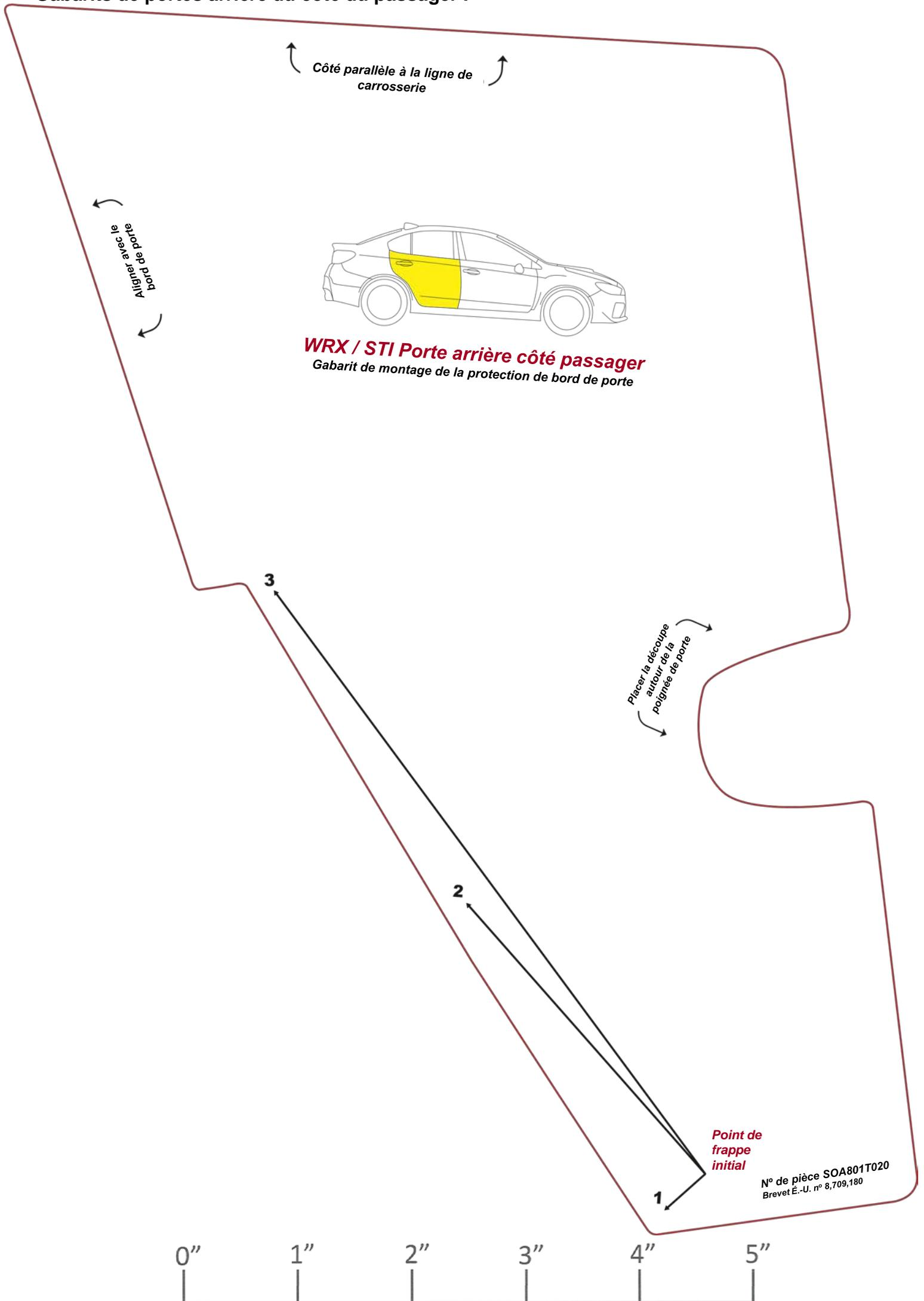
Directive d'installation au concessionnaire : Pour assurer des dimensions d'impression appropriées, réglez la dimension de page à « Légal » dans l'onglet des propriétés de l'imprimante et « Taille réelle » dans l'onglet des dimensions et du traitement de la page. Vérifier que l'échelle est exacte à 1:1. Dans le cas contraire, régler le photocopieur.
